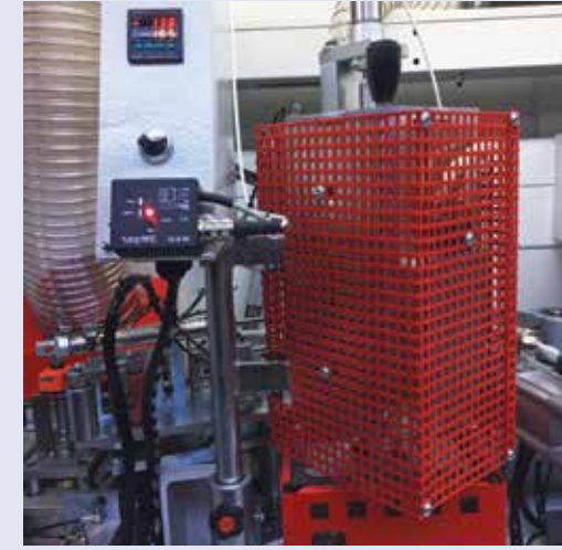
Sıcak Tutkal Besleme Sistemi (Opsiyon) Hot Glue Feeding System (Optional)
