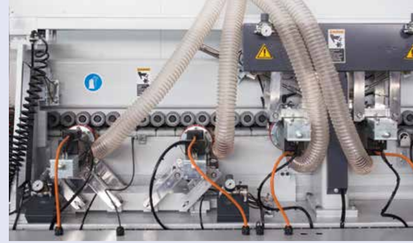
180° Dönüş Köşe Yuvarlama Ünitesi 180° Rotation Trimming Unit
