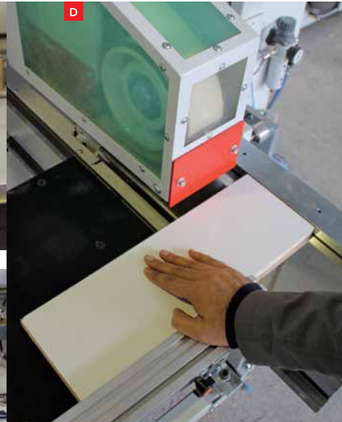
D Dar Parça Besleme Ünitesi / OPSİYONEL Narrow Part Feeding Unit / OPTIONAL
