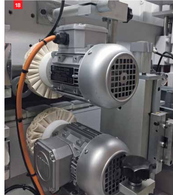
18 Polisaj Temizleme Ünitesi Polisage Unit
